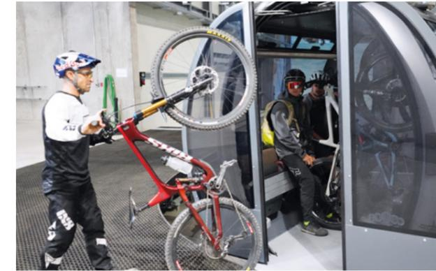
Die grundlegende Idee des Ropetaxi besteht darin, dass sich die Kabinen in der Station autonom fortbewegen, was durch einen neuartigen Antrieb direkt an der Seilklemme ermöglicht wird.
