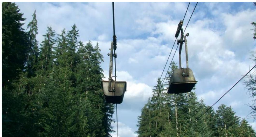
Nachdem ausreichendes Gipsvorkommen im Abbauggebiet gegeben ist, erschien es zweckmäßig die Materialeseilbahn für den Weiterbetrieb zu revitalisieren. Hier wird eine Betriebsdauer für die nächsten 30-40 Jahre angestrebt. Die Zielsetzungen des Kunden waren, dass der Betrieb der Anlage in Zukunft einen geringeren Personaleinsatz erfordert und somit wirtschaftlicher ist. Des Weiteren soll eine zusätzliche Beschickung von der Antriebsstation Auermahd aus erfolgen.
